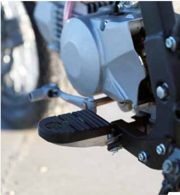
RUBBER FOOT PEG COVER CAOUTCHOUC SUPÉRIEUR DE REPOSE PIED
