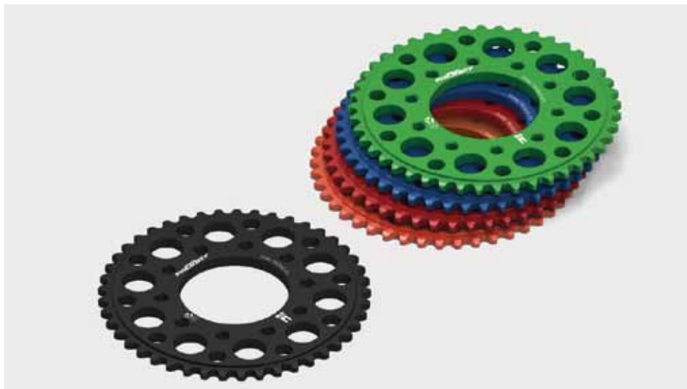
COURONNE ALU, TAILLÉE DANS LA MASSE - 5 TROUS DE FIXATION - DISPONIBLE EN 41, 43, 45, 47 DENTS NOIRE/ VERTE/ BLEUE/ ROUGE/ ORANGE - Ø INTÉRIEUR 75 - ENTRAXE COURONNE 92 BILLET ALUMINIUM SPROCKET - 5 HOLE FIXATION - 41, 43, 45, 47 BLACK/ GREEN/ BLUE/ RED/ ORANGE
